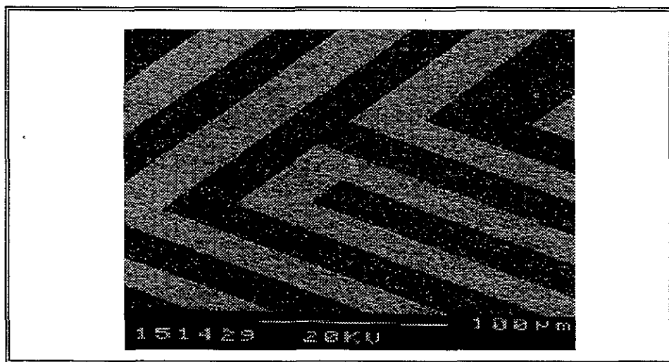
Figura 5.13. Pistas conductoras realizadas por erosionado.
