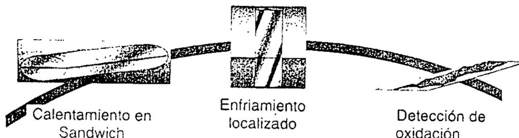
Fig. VI.10. Crecimiento de whiskers dentro de un sandwich de medias caña de acero
