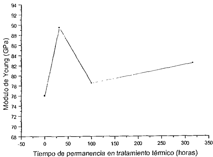
Figura 32. Gráfica que muestra el comportamiento del módulo de Young para 4 muestras sometidas a tratamientos térmicos a 500°C con distintos tiempos de permanencia.
