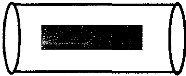
Figura 2.4.1. Guía de onda circular con dieléctrico.
