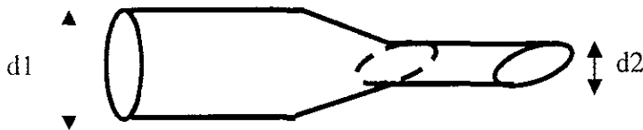
Figura 2.4.3. Guía de onda circular con reducción del diámetro d1 al diámetro d2 .
