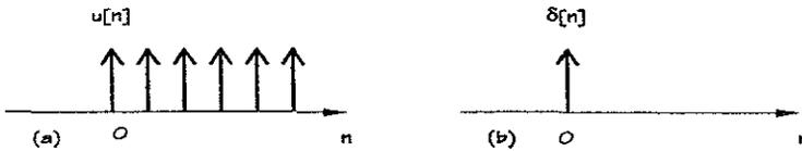
Figura 1.1: Representación gráfica de la secuencia escalón (a) y la secuencia delta (b).
