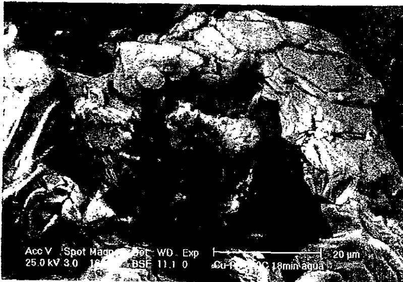
Fig. 5.14. Estructura laminar rodeando una partícula de cobre. El cobre facilita la existencia de varios puntos de nucleación. Muestra obtenida a 820°C y 18 minutos en el horno, enfiada con agua. Imagen a 1800x.
