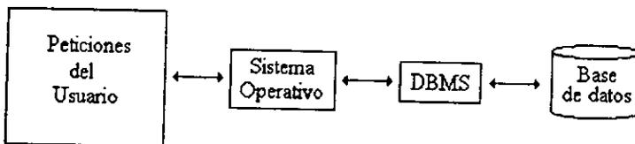
Diagrama de un Sistema de Bases de Datos.
