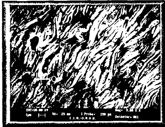
Figura 4.6 Microfotografía obtenida a través de microscopía electrónica de barrido (SEM). Gracias al aumento obtenido, podemos observar con claridad la morfología de las partículas que posee la muestra. En primer lugar destacan las partículas de forma alargada cuyos tamaños estuvieron entre los 10 y 15 \mu\text{m} de largo y < 1 \mu\text{m} de ancho. También son observables partículas de forma irregular ricas en cromo, las cuales son señaladas por medio de flechas.
