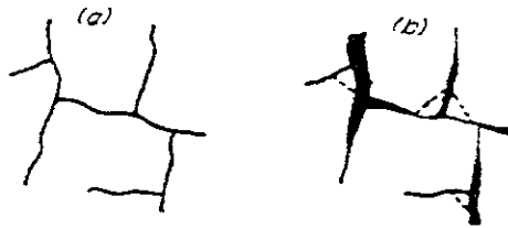
fig. 5.1 18 Sección a través de la masa de una arcilla resistente fisurada. a) fisuras viejas, cerradas antes de que una excavación disminuya la tensión a que está sometida la arcilla; b) con la disminución de tensión, las fisuras se abren y el agua, al circular por las mismas ablandan la arcilla de sus paredes.
