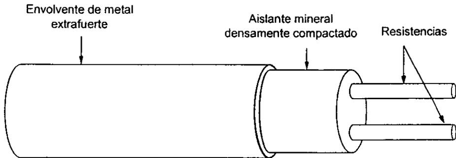
Fig. 4.3 Construcción estándar de los cables con aislante mineral.
