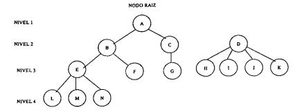
UN ARBOL SE COMPONE DE NODOS. CADA NODO CONTIENE ELEMENTOS DE DATOS QUE CONSTITUYEN UN TIPO DE REGISTRO O ENTIDAD. EL NODO UNICO EN EL NIVELI ES UN NODO RAIZ.
