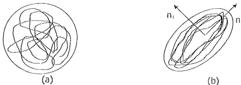
**Figura 1.1.** Diferencia entre los estados isotrópico y anisotrópico en un material polimérico. En (a) no existen esfuerzos deviatorios, por lo que no presenta direcciones definidas, mientras que en (b) se presenta una deformación promedio inducida mediante esfuerzos por lo que la dirección del flujo establece una dirección preferencial. La birrefringencia del material en el estado anisotrópico es la diferencia entre los índices de refracción en las direcciones  $n_1$  y  $n_2$ .
