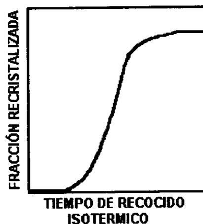
Figura 2.9. Fracción recristalizada versus el tiempo de recocido isotérmico<sup>(30)</sup>.
