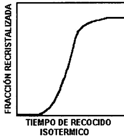
**Figura 3.4.** Representación esquemática de la cinética de transformación isotérmica para una transformación sólido-sólido térmicamente activada.
