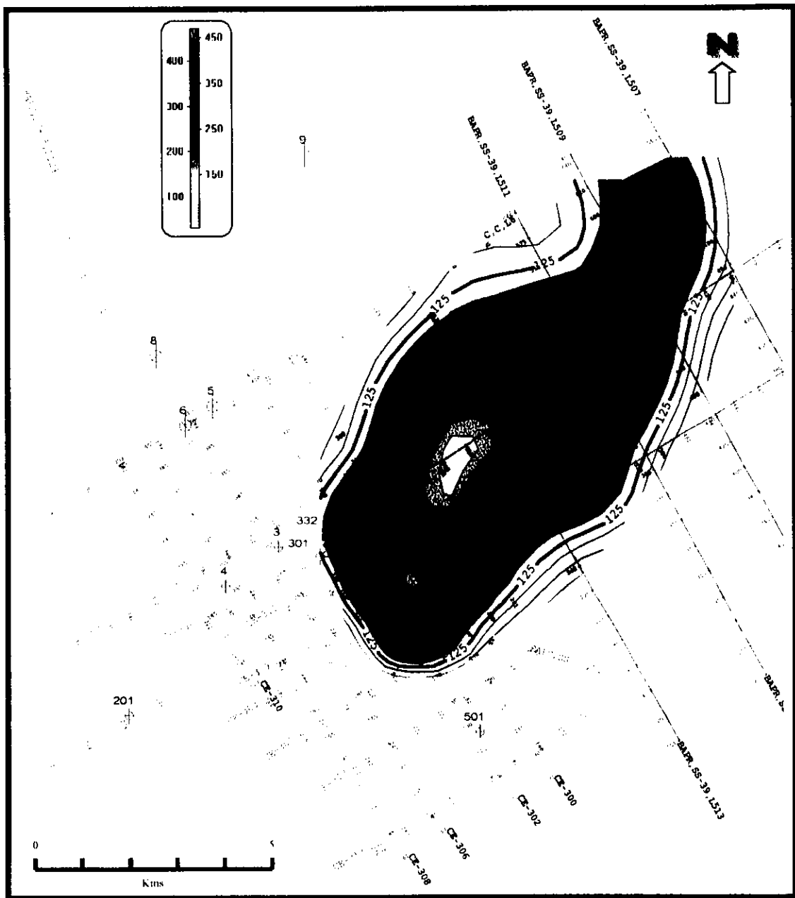
Fig. 4.3.- Mapa de isopacas del abanico turbidítico-1 (Intervalo cada 25 m.) donde se observa claramente la extensión y espesor del mismo. La dirección de aporte de los sedimentos se infiere que es de SW a NE.
