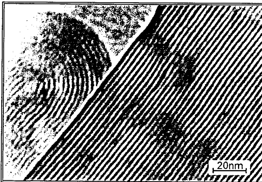
Figura 4.13 Fase laminar y "huella digital" en la muestra 25MCM3.3 - 140°C preparada en condiciones hidrotérmicas
