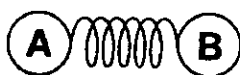
Fig. 2.1. La vibración de dos átomos se puede ver como la vibración de dos masas unidas por un resorte.
