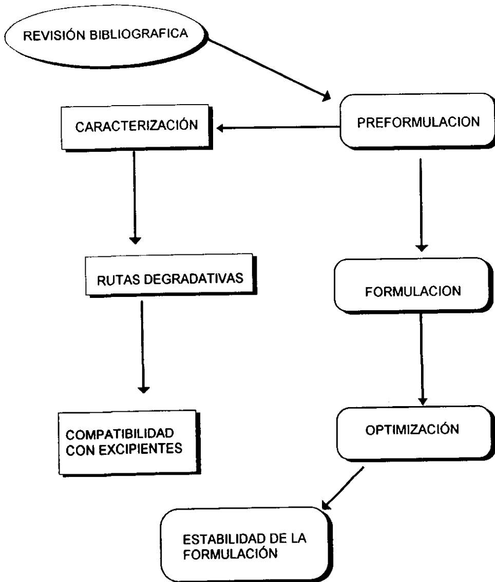
Figura 3. Diagrama de la metodología general para obtener la formulación de tabletas de Tolbutamida.
