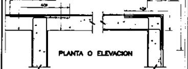
**DETALLE TIPO DE ANCLAJES EXTREMOS**
