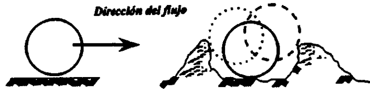
Figura 4.4. Efectos del oleaje sobre el lecho marino en presencia de una tubería
