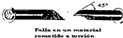
Figura 3.2 Falla en un material sometido a torsión.
