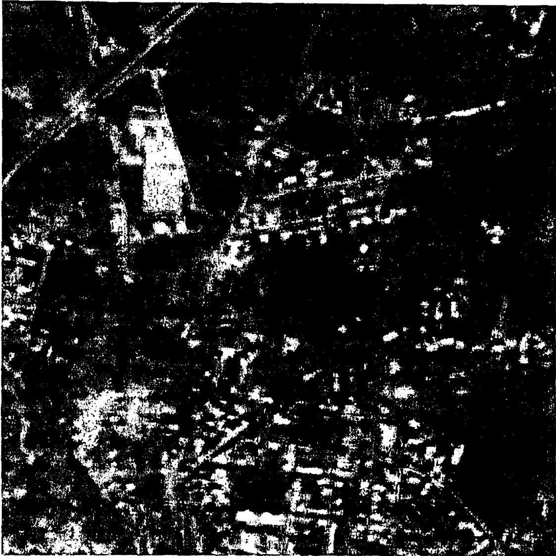
Imagen 4.20. Aplicación de un filtro paso bajas con una mascara de 5x5
