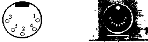
Fig. C.10. Conector tipo DIN-5 con terminales tipo hembra. (Vista de frente)
