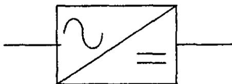
Figura 1.- Rectificador/Cargador
