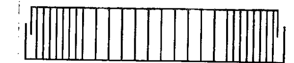
GRÁFICO 50. COLOCACIÓN DE ESTRIBOS
