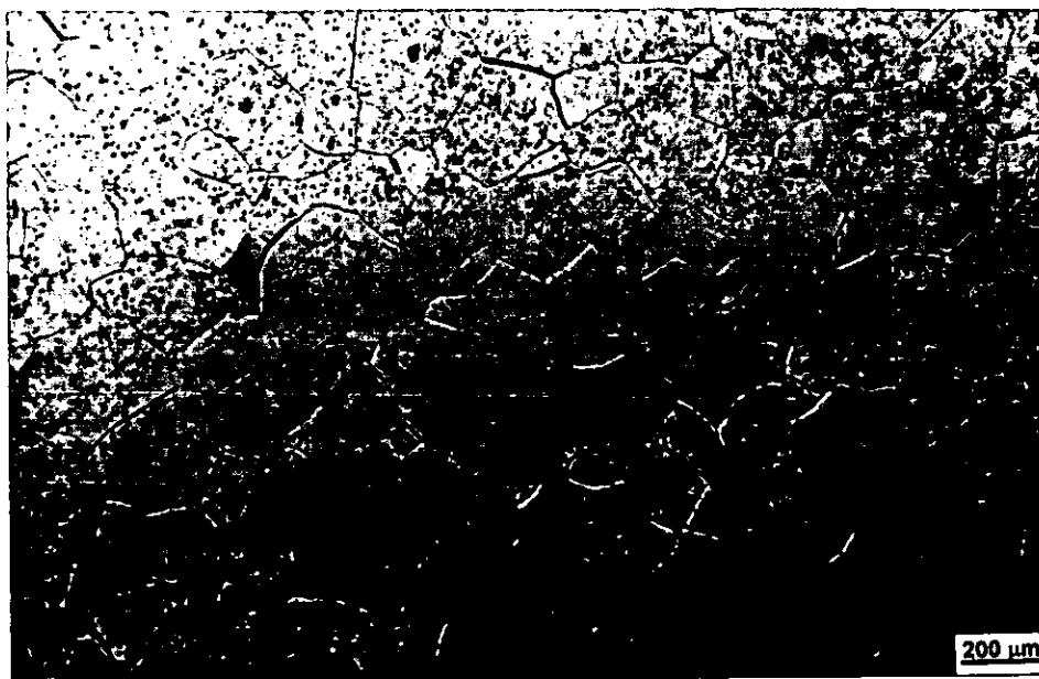
Figura 3.3 Microestructura inicial de la aleación FeAl40at.%, (FA).
