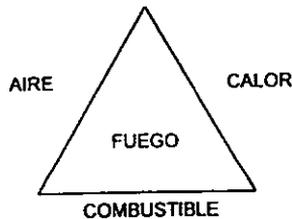
Como puede verse, para que una condición de fuego exista las tres condiciones antes señaladas son requeridas, una fuente de ignición, el oxígeno y un combustible, por lo tanto, en cualquier sistema de prevención de fuego, la señal del detector de fuego, desencadena la acción de algún sistema que reduzca la concentración de alguno de estos elementos altamente potenciales para la generación de un incendio.
