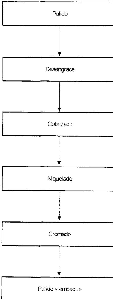
Este proceso debe ser en esta secuencia y al final del proceso, la unión de las capas de cobrizado niquelado y el acabado de cromo da como resultado una resistente capa adherida a la pieza metálica, que tiene la capacidad de proteger y no dañarlo.
