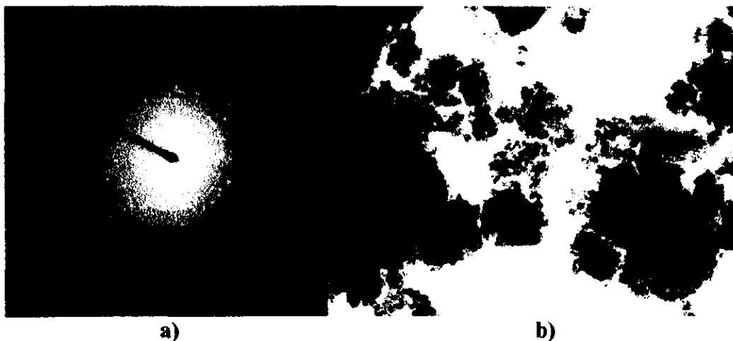
Micrografia de ZrSNA(1). 7a) patrón de anillos característico de muestras con alúmina y 7b) su imagen de campo claro asociada
