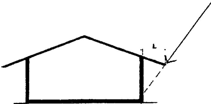
Fig. 5.2.24. A pesar de que presenta la misma L (medida del alero), el alero no evita la incidencia del sol sobre los muros.
