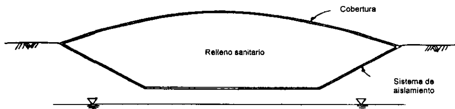
B) Relleno sanitario dentro de una excavación o en un valle preexistente
