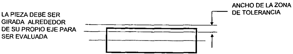
Figura 1.18. Muestra la forma esquemática del cabeceo
