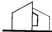
TECHO INCLINADO PARA LOGRAR UN DESAGÜE RÁPIDO
