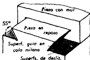
Figura 3.2.9.a Superficies de deslizamiento y de guía en una vía de cola de milano.
