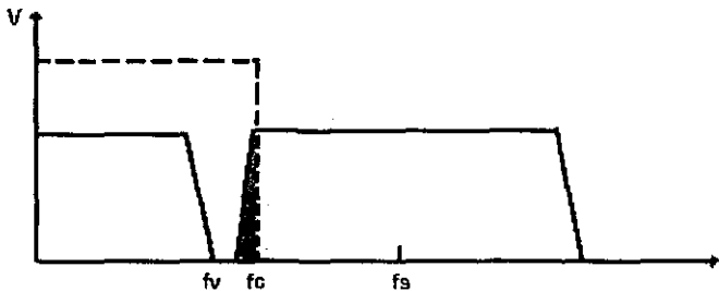
FIG. II.8 OTRA CAUSA DE "ALIASING" ES POR UNA ELECCIÓN ERRÓNEA DE LA FRECUENCIA DE CORTE f_c DEL FILTRO PASA-BAJAS (CUANDO f_c > F_s - F_v )
