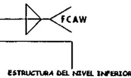
Para la unión de la estructura en ángulo en la parte inferior del piso, se utilizará soldadura de arco eléctrico de filar con núcleo fundente (Flux Cored Arc Welding (FCAW)) de manera intermitente con el fin de dador la menos posible la superficie de la lámina antiderropeante. La operación se realizará por todo el perímetro del ángulo que forma la estructura del piso
