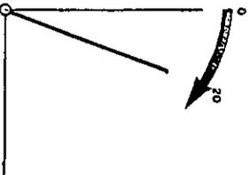
El desplazamiento que tiene la palanca de toma de fuerza se realiza en un solo momento (ascendente-empujada) hacia atrás, girando aproximadamente 20° con respecto al plano que hace la conexión original de este elemento.
