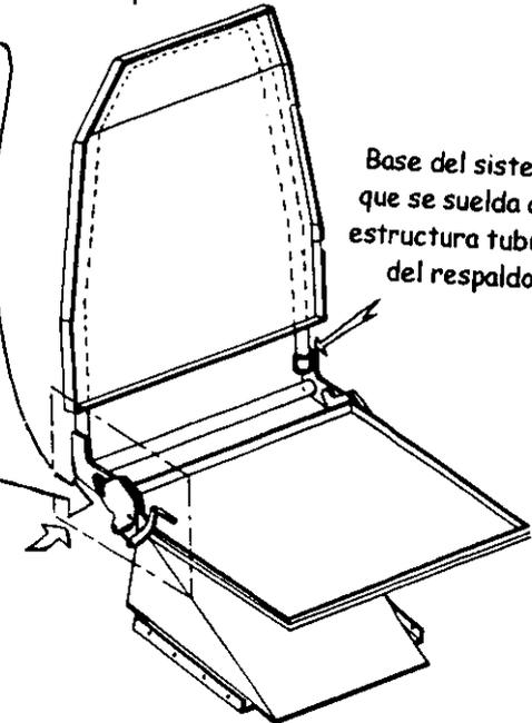
Base del sistema que se suelda a la estructura tubular del respaldo
