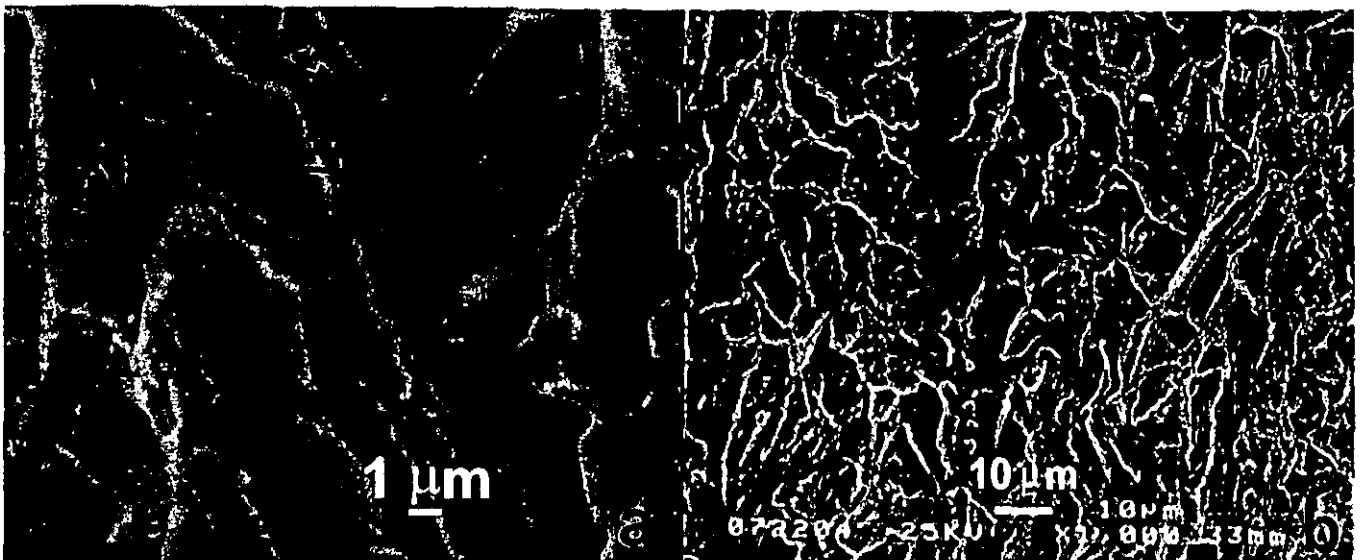
Figura 4.17 Superficie de fractura de la muestra T-L evaluada a 50 \text{ MPa} \cdot \text{m}^{1/2} . (a) Detalle de la fractura frágil encontrada en la región de la punta de la grieta. (b) Grietas alternas producidas en los alrededores de la punta.
