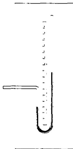
Figura 4.3 Manómetro diferencial abierto.
