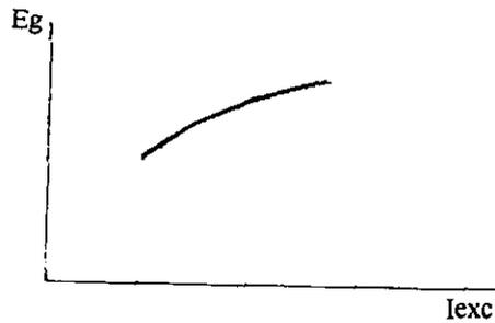
**Fig.1.** La curva de vacío del generador de c.d.
