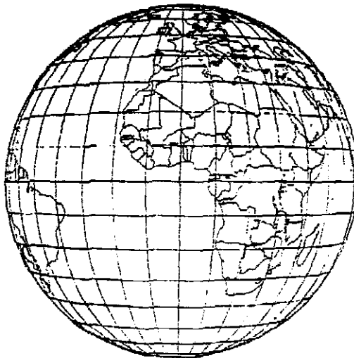
Cobertura global (ángulo de visión de 17,4^\circ ) desde la posición geostacionaria de 0^\circ .
