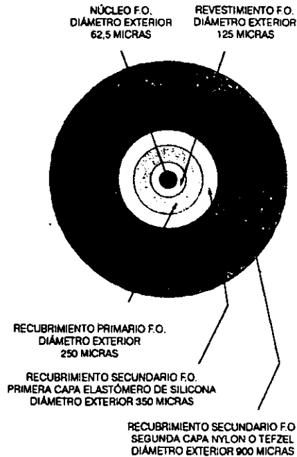
Figura 3.1. Construcción del núcleo óptico con una protección secundaria conforme la técnica de la estructura ajustada
