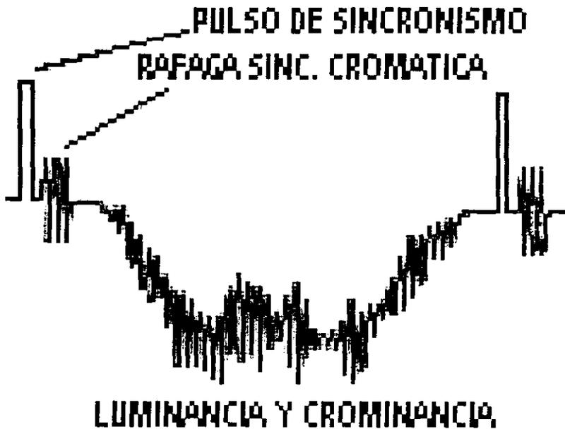
Figura 1-5 Señal compuesta de video de color.
