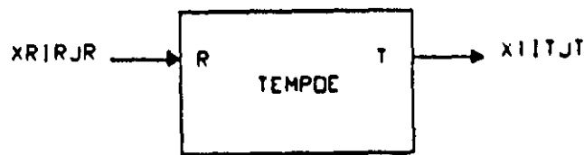
Figura 3.39 Representación genérica de un temporizador estable realizable en el PLM.
