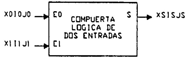
Figura 3.6 Representación genérica de una compuerta de dos entradas realizada por el PLM
