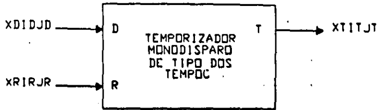
Figura 3.31 Representación genérica de un temporizador monodisparo de tipo dos.
