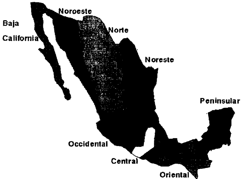
Áreas de control del Sistema Eléctrico Nacional
