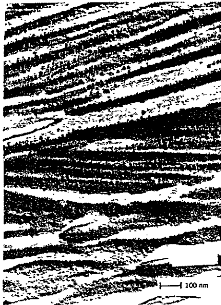
Figura3.5.- Microfotografía en transmisión electrónica de un copoliéster sometido a estiramiento cerca del punto de cedencia. Fuente: Thermoplastic elastomer N.R. Legge, G.Holden, H.E. Schroeder
