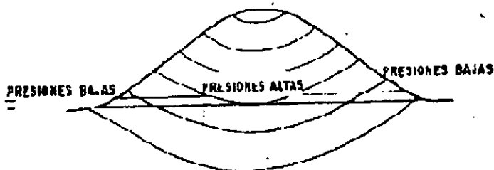
Fig. 2 Variación de las presiones a lo largo de un túnel en un sinclinal
