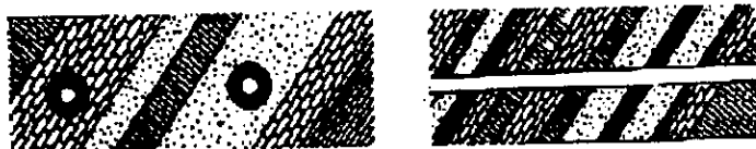
Fig. 4 Posición del túnel con respecto al rumbo y al echado de las capas.
