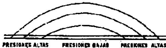
Fig. 1 Variación de las presiones a lo largo de un túnel en un anticlinal.
