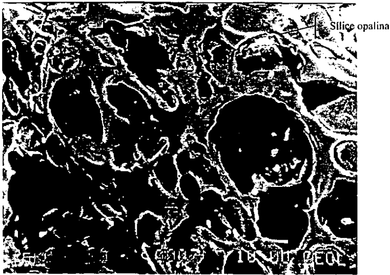
Figura 22 En el perfil M2, se observa gran el cementante rodeando y mezclándose con la matriz fina del material.
