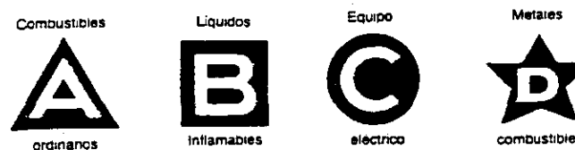
Fig. 19-1C. Símbolos exhibidos en los extintores para indicar los tipos de fuego contra los que son aptos. También forma parte del sistema de identificación una clave de color, según la cual el triángulo (Clase A) es verde, el cuadrado (Clase B) es rojo, el círculo (Clase C) es azul y la estrella de cinco puntas (Clase D) es amarilla.
