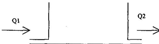
Figura 1.5 Un tanque se opone a variaciones en la presión.
