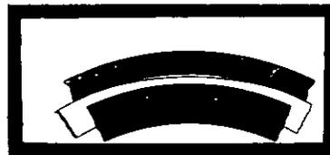
fig: 6-35 Mal ajuste de anillo respecto a la pared del cilindro
