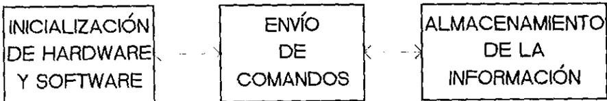
Figura 3.4.17 Diagrama a bloques del programa PRUEBA.
