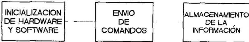
Figura 3.4.3 Diagrama a bloques del programa GUARDA.
